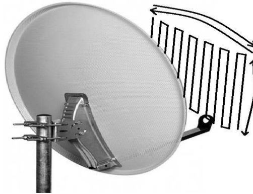
الشكل (4-16) حركة الهوائي أثناء عملية البحث
