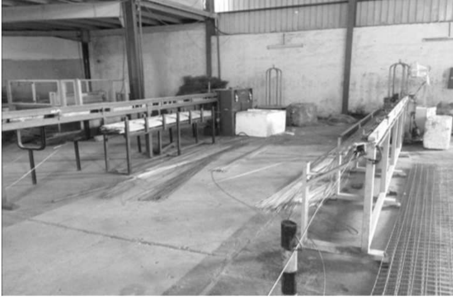
الصورة (2-2) توضح اسلاك الفولاذ بعد السحب
