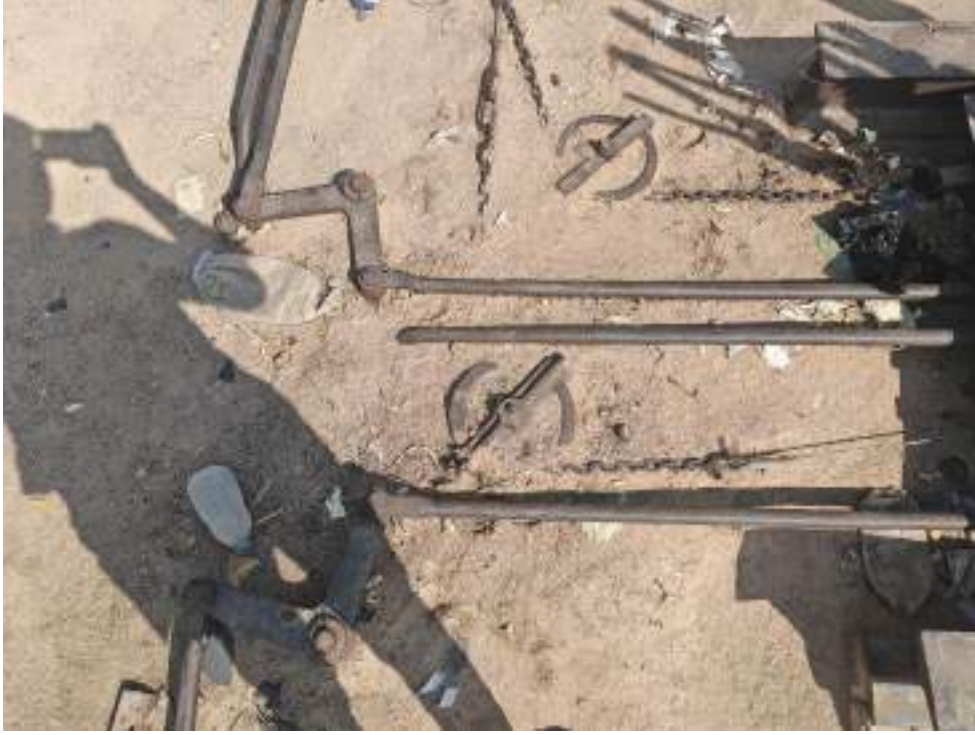
صورة 3-3-13 ( أجزاء مفتاح التحويلة )
