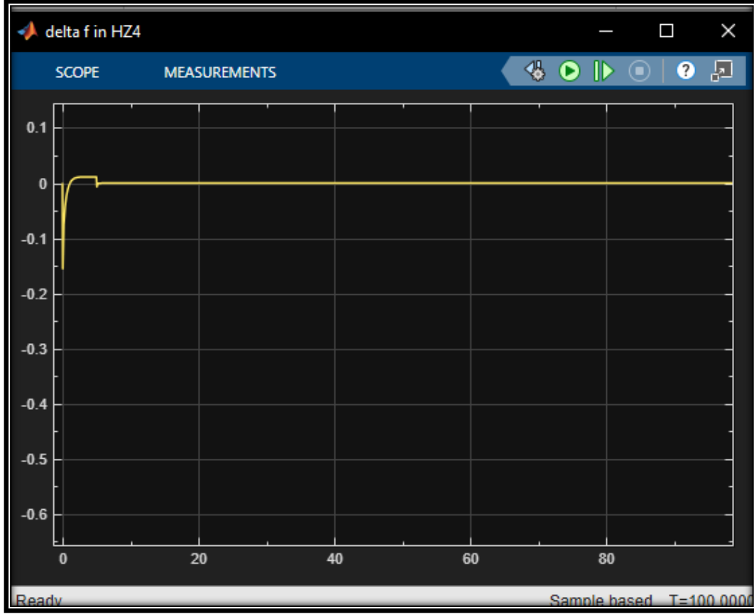
شكل (3-4) استجابة تردد النظام باستخدام متحكم PID
