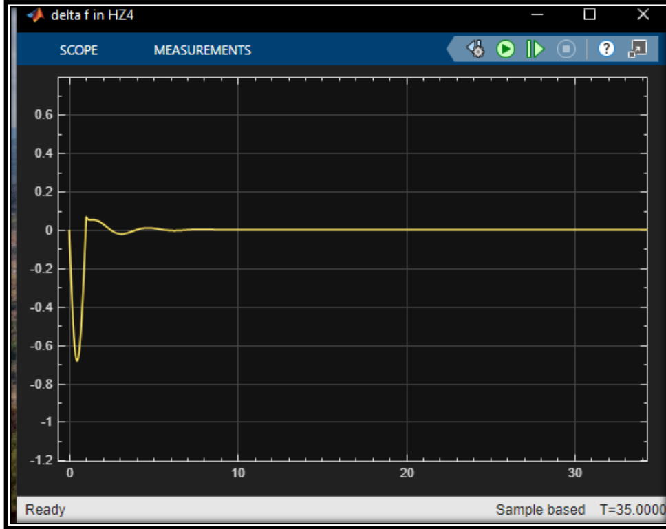
شكل ( 2-4 ) استجابة التردد للنظام بمتحكم PI
