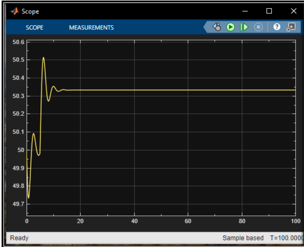
شكل ( 4-1 ) استجابة التردد للنظام بدون متحكم
