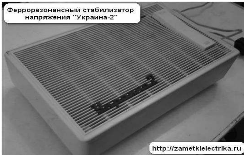
الشكل (2-2) يوضح مثبت الجهد بالرنين المغناطيسي
