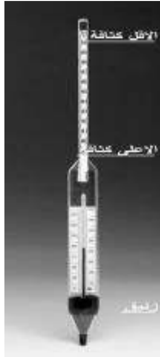
شكل رقم (٢-٣) توضيح: جهاز الهيدرومتر
