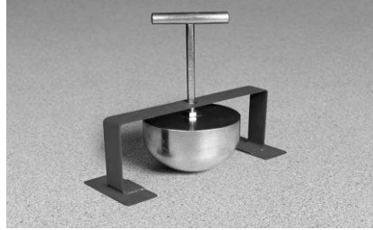
شكل رقم (٣-١٢) جهاز كرة كيلي لقياس القوام.
