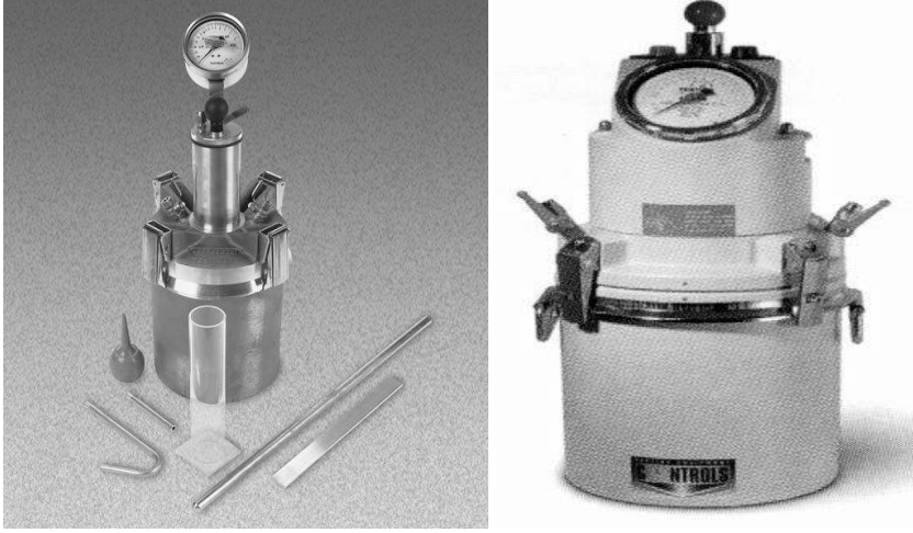
شكل رقم (١٥-٣) جهاز تعيين نسبة الفراغات في الخرسانة الطازجة
