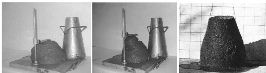
شكل رقم (٣-٩) قالب اختبار الهبوط وقضيب الدمك.
