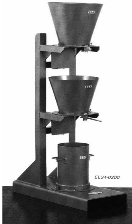
شكل رقم (٣-١٣) جهاز عامل الدمك.
