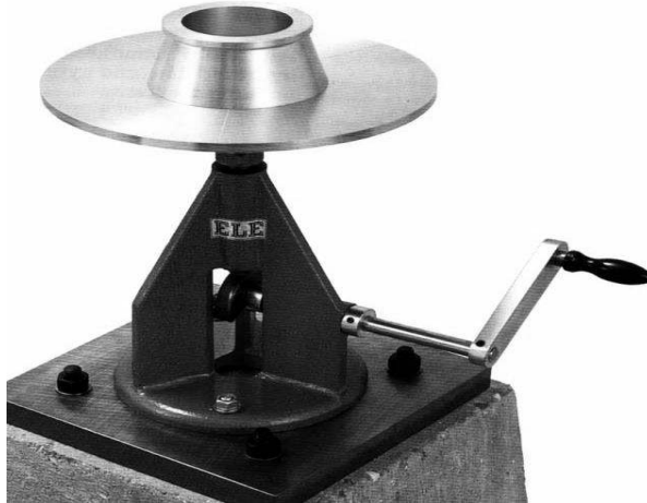
شكل رقم (١١-٣) جهاز الانسياب لتحديد القوام.
