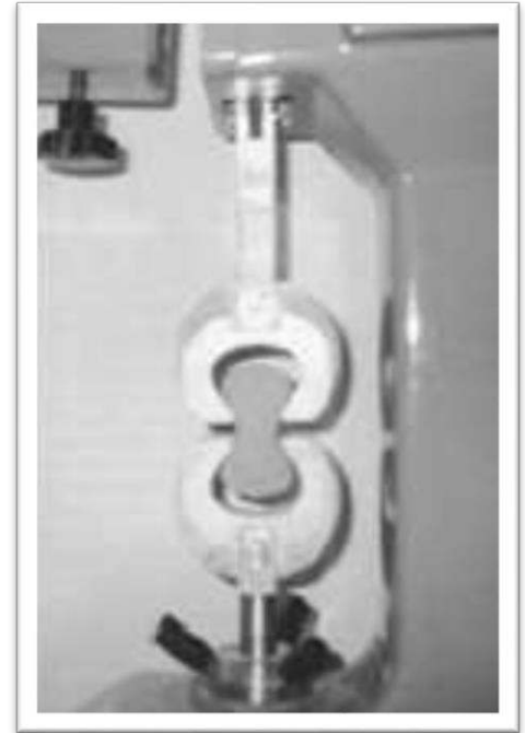
شكل رقم (٧-٣) توضيح قالب عينة مقاومة الشد وكلاية ماكينة مقاومة الشد للمونة الأسمنتية
