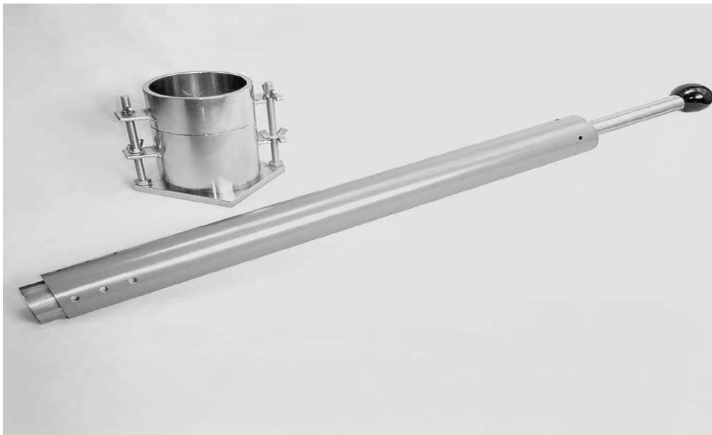
شكل رقم (٢-٤) القالب القياسي لدمك التربة في المعمل
