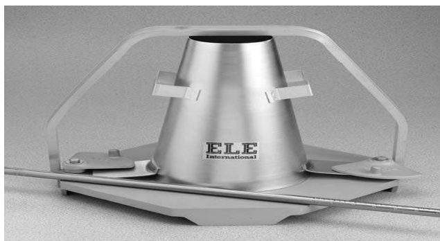
شكل رقم (٣-٩) قالب اختبار الهبوط وقضيب الدمك.
