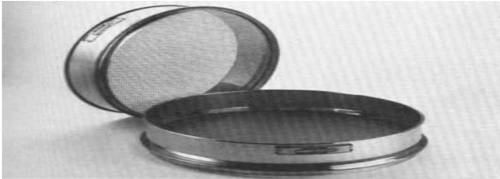
شكل رقم (١-٣) توضيح المنخل القياسي ١٧٠ والصينية السفلية.
