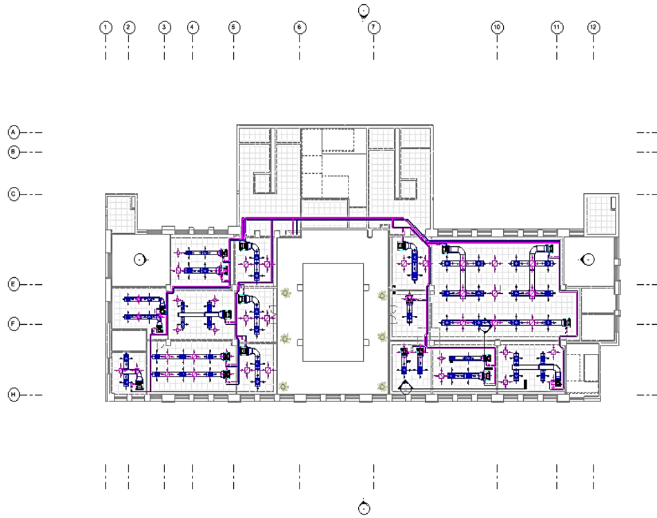
شكل (11-5) يوضح مخطط تصميمي لتوزيع شبكة المياه المبردة في الطابق الأول
