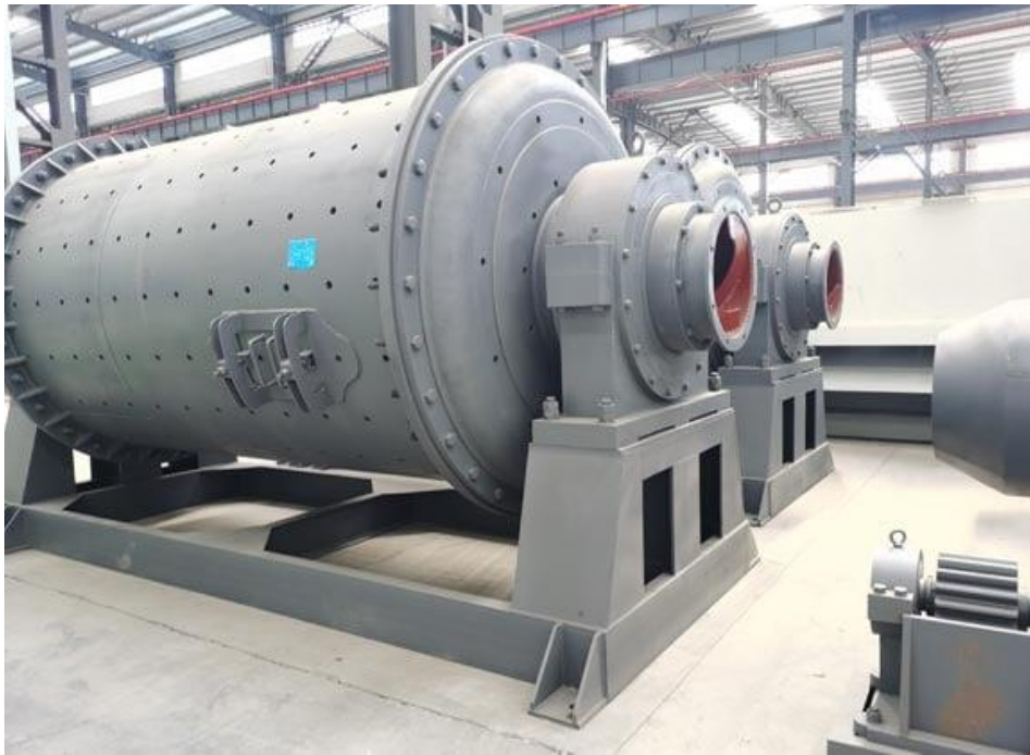
شكل 2.2: مطحنة الكرة الأسمنتية لإنتاج مسحوق الأسمنت
