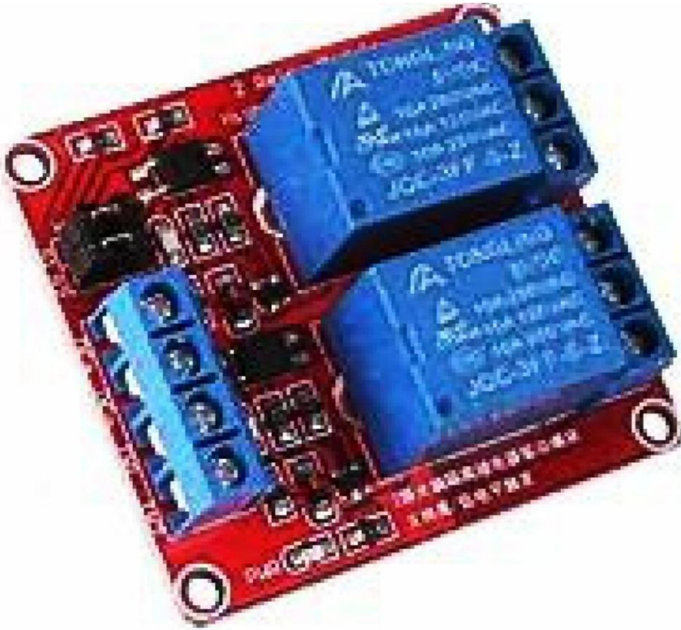
الشكل (3_4): يوضح الريليه (Relay Module) لتشغيل وفصل الأجهزة.
