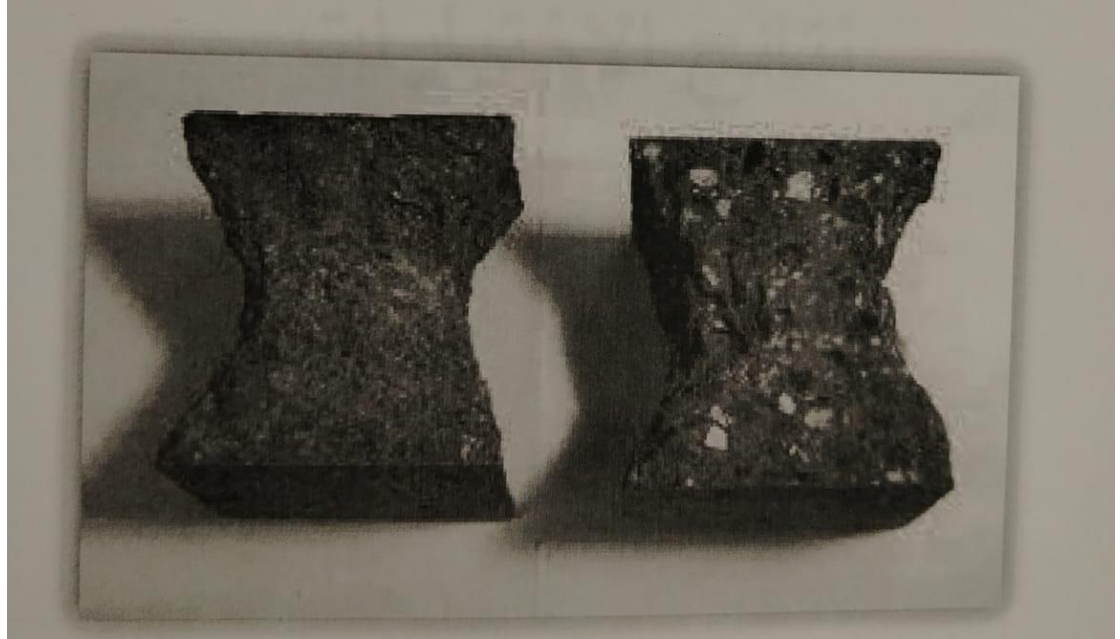
الشكل (3-8) يوضح شكل الكسر في عينات خرسانية مكعبة بعد إجراء اختبار الضغط عليها
