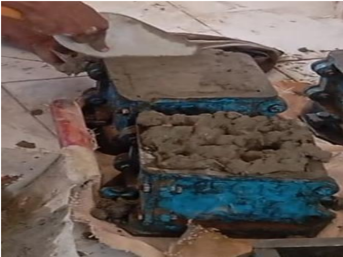
صورة لصب الخلطة الخرسانية داخل المكعب
