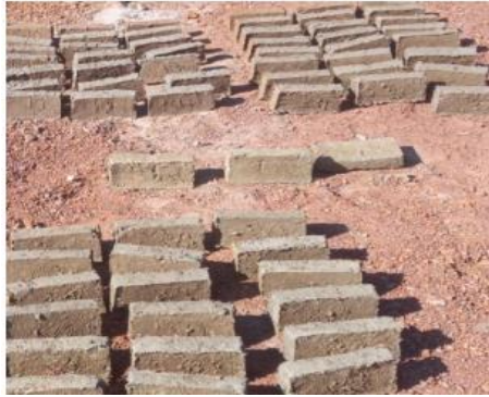
صورة رقم (2-3) توضح تجفيف الطوب
