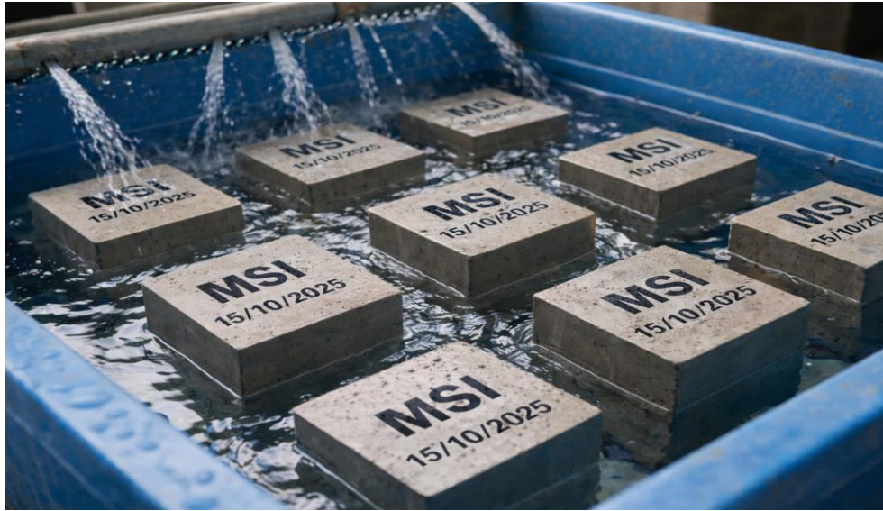
الشكل (3-8) يوضح طريقة المعالجة في الماء
