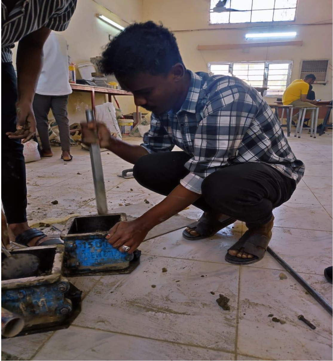
صورة (3-5) توضح عملية الدمك
