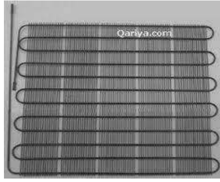
شكل: رقم (2-9) المكثفات الجوية
