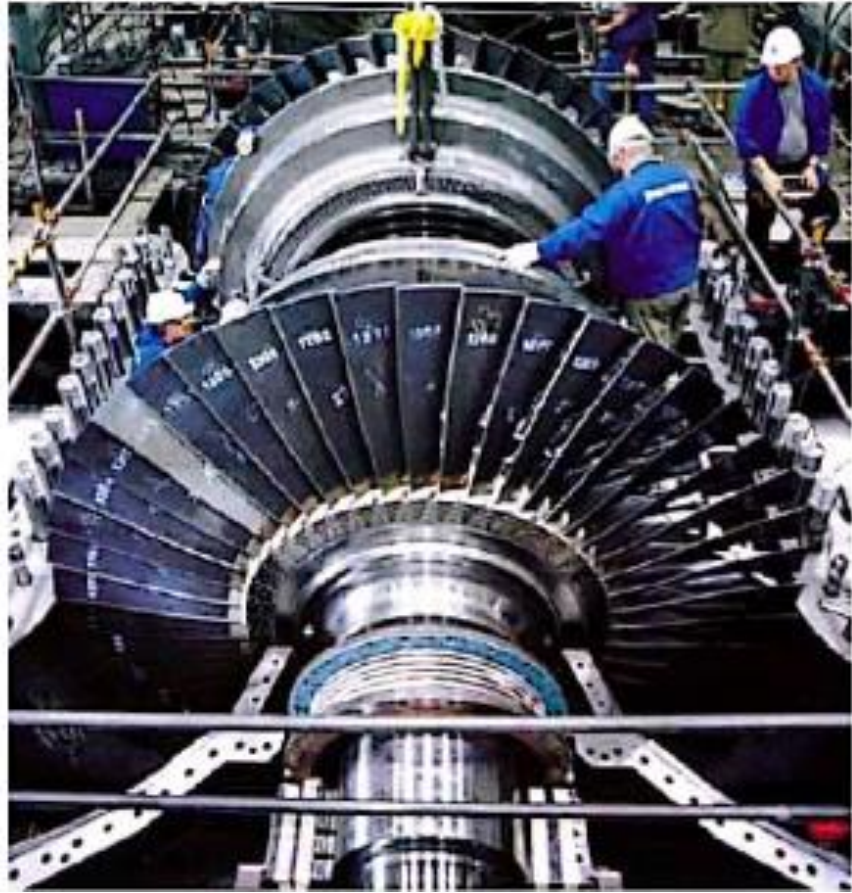
الشكل (٧-٢) صورة فتوغرافية لأحد التوربينات البخارية الكبيرة تحت الصيانة
